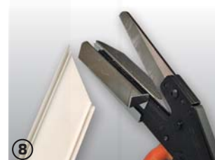
7 ustřížení úhlu 45° krytu lišty střížením podle rysky na opěrné ploše nůžek
