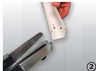
2 45°-vým stříhem vznikne pomyslný bod určující místo dostřížení stěny lišty (viz bod 3)
