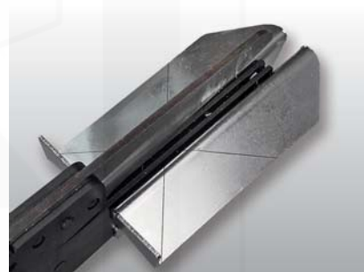
pomocné rysky na opěrné ploše nůžek, pro stříhání úhlu 45°
