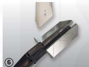
2 45°-vým stříhem vznikne pomyslný bod určující místo dostřížení stěny lišty (viz bod 3)
