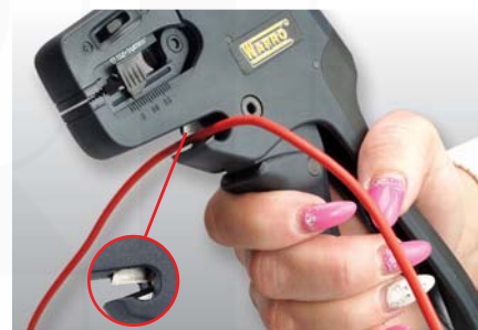
velmi ostrý nůž umožňuje rychlé a komfortní stříhání vodičů (Cu a Al lanka do 10 mm 2 , Cu a Al pevné dráty do 2,5 mm 2 ).
