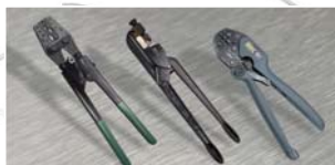
Lisovací nářadí na izolovaná očka, spojky, kolíky a konektory (0,14 - 95 mm 2 )
