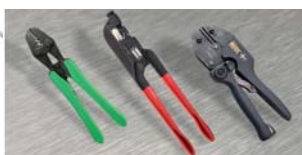
Lisovací nářadí na stáčená oka, spojky a kolíky bez izolace (0,25 - 120 mm 2 )
