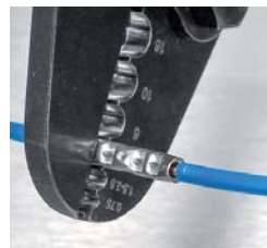
ukázka lisování pevných drátů (0,5 - 6 mm 2 )
