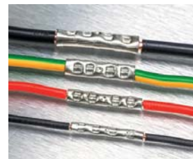
ukázka lisování pevných drátů (0,5 - 6 mm 2 )
