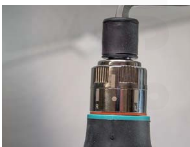
otočným zámkem lze přepínat směr ráčny nebo ráčnu uzamknout
