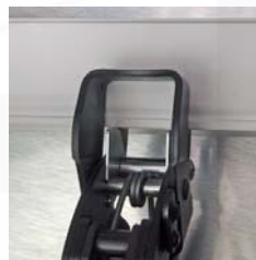
ukázka výkroje kleštěmi "VAMPIR 26" s použitím dorazu pro výšku výkroje 15 mm
