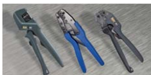
Lisovací nářadí na koncovky a spojky s teplem smrštitelnou izolací (0,5 - 6 mm 2 )
