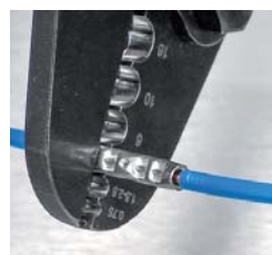
ukázka lisování pevných drátů (0,5 - 6 mm 2 )
