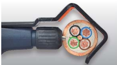
řezný nůž z vysoce kvalitní tvrzené oceli lze přesně nastavit otáčením horní části nástroje na potřebnou hloubku řezu až do 4,5 mm
