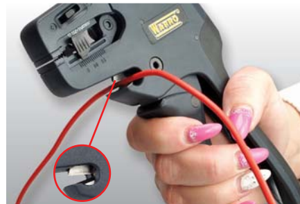
velmi ostrý nůž umožňuje rychlé a komfortní stříhání vodičů (Cu a Al lanka do 10 mm 2 , Cu a Al pevné dráty do 2,5 mm 2 ).
